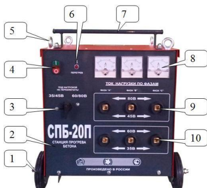
Рис. 1. Общий вид и устройство трансформатора.
